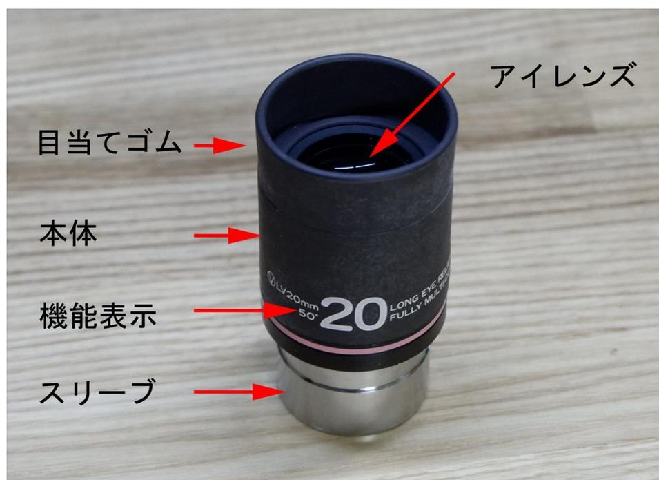
アイピース・ガードはアイピースのアイレンズに目やまつげが直接触れないようにするものです。暗闇でアイピースに目をぶつける危険も防げるものです。ガード本体に使用するアイピースの機能表示が明記されていますので、照合してお使いください。
