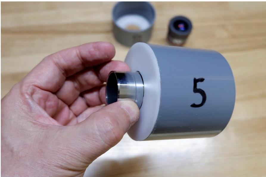
望遠鏡に差し込むときは、逆にアイピース本体を持ち、望遠鏡のアイピースホルダーにしっかり差し込み、ロックねじで固定します。
